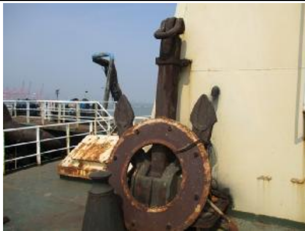
1.15 艙部备锚固定到位
