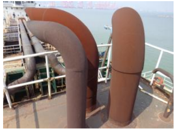
1.14 艙部主机排气管
