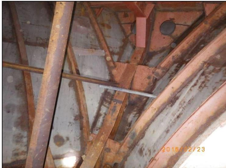
33. 艏空舱左舷舷侧结构,发现一处凹陷变形
