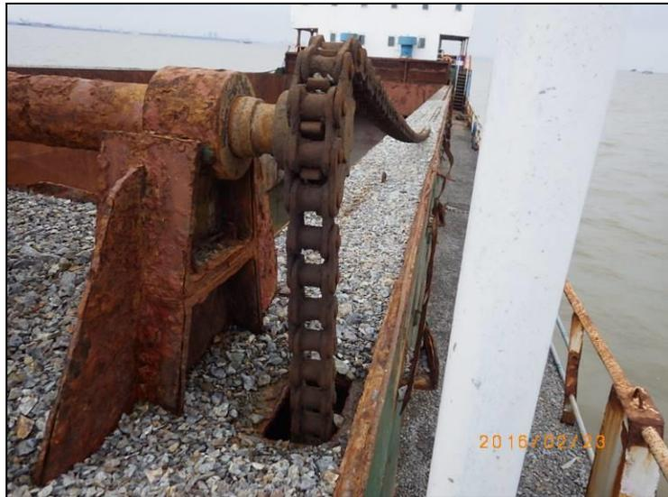
66. 舱间桅屋顶布置有舱盖链条驱动电机，但未能外观检查
