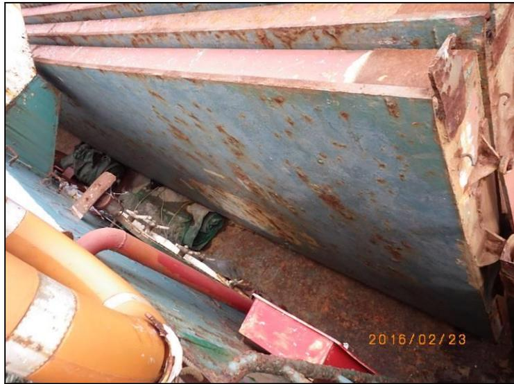
72. 2号货舱舱盖横向侧板,局部复板修补
