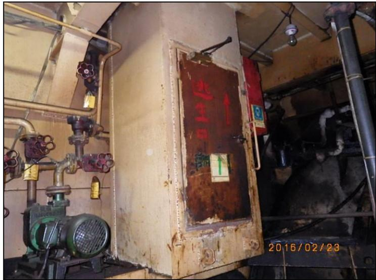
159. 机舱风油切断和速闭阀关闭装置
