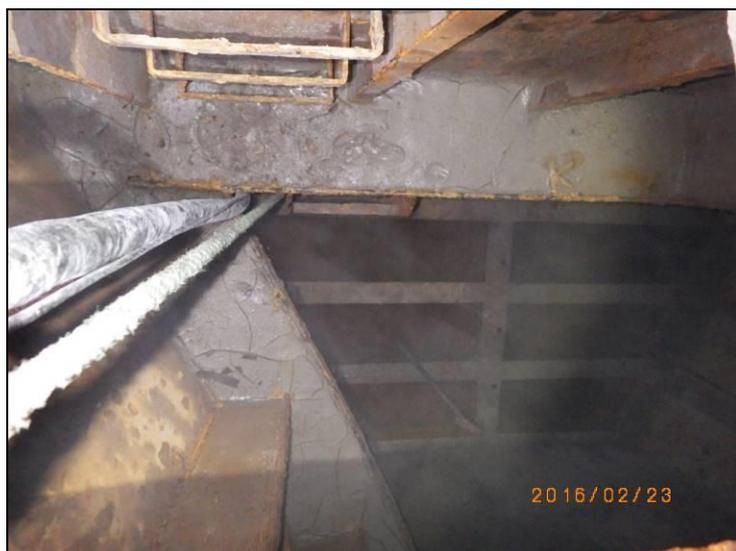
31. 艏尖舱道门处发现软管和潜水泵
