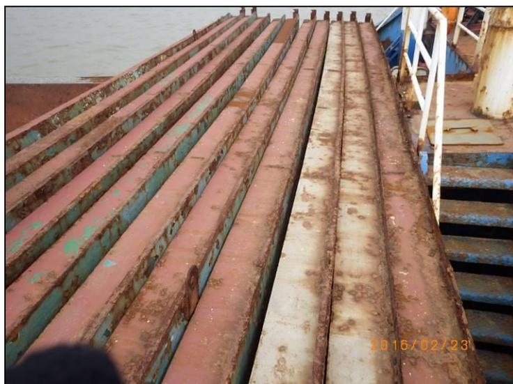
58. 1号货舱舱盖横侧板局部锈烂、采用复补修理
