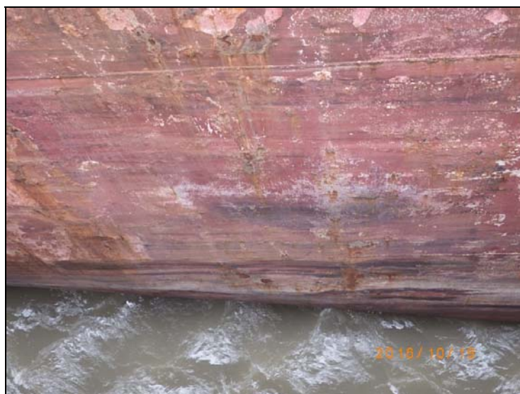
9. 右舷船中外板局部 凹陷变形
