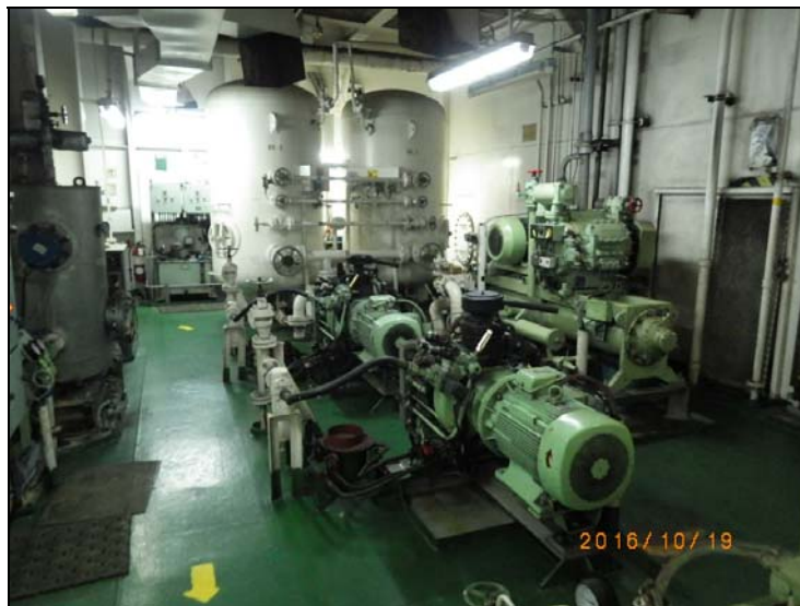
143. 机舱上平台层,主空压机和空气瓶
