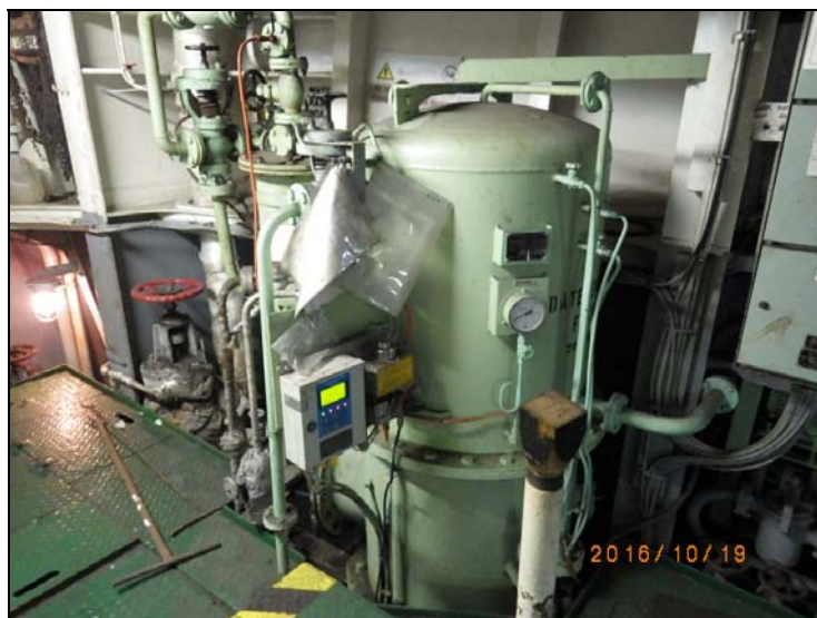
125. 机舱底层, 油污水分 离器
