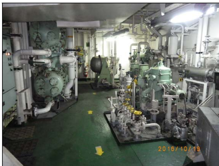
129. 机舱下平台层,淡水、滑油冷却器
