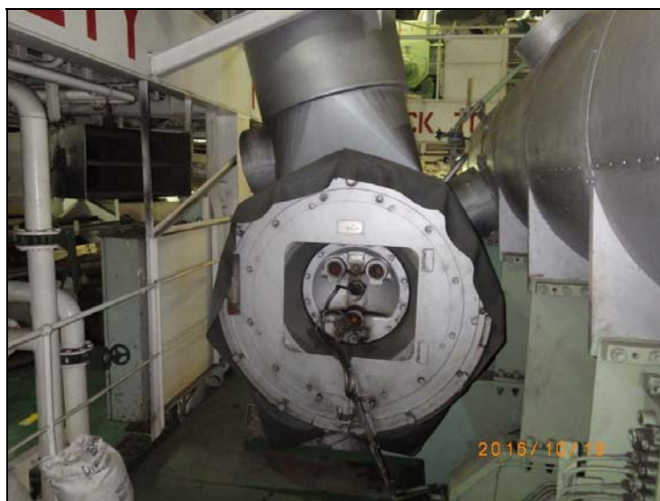
123. 主机废气涡轮增压器
